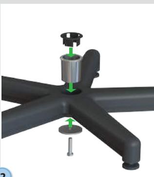
2 An der Unterseite des Fußes legen Sie erst die Scheibe auf und drehen dann die Schraube durch den Fuß in das Oberteil.
