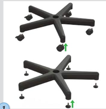
1 Die 5 Rollen/ Gleiter in die Aufnahme des Kunststofffußes bis zum einrasten eindrücken.
