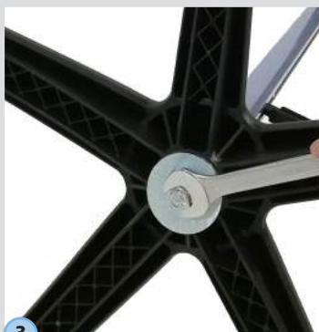
3 Die Schraube (M10 x 50) mit dem beiliegenden 17er Schlüssel festziehen.
